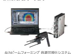
4chビームフォーミング 音源可視化システム
