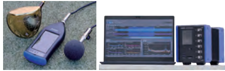
高機能騒音計 LAシリーズ (左) 音響振動解析システム O-Solution DS-5000 (右) 今回提案した高機能騒音計 LA-7500と音響振動解析システム O-Solution DS-5000(オプションのFFT解析パック OS-5120を追加)
