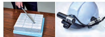
打撃&擦過打診でアルゴリズム診断
