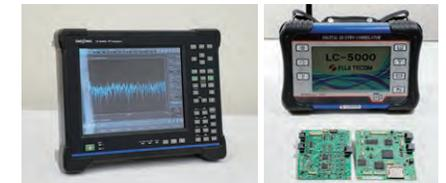
LC-5000は、小野測器が外部で組み立てた筐体に基盤を組み込み、半完成状態でフジテコムに納品。画面UIのデザインにも関与。CF-9400A等で培った信号処理技術が活かされている
