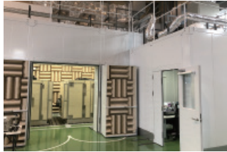
トランスミッション NV評価用ベンチ
