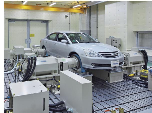
RC-S(実車トランジェントベンチ)での使用例
