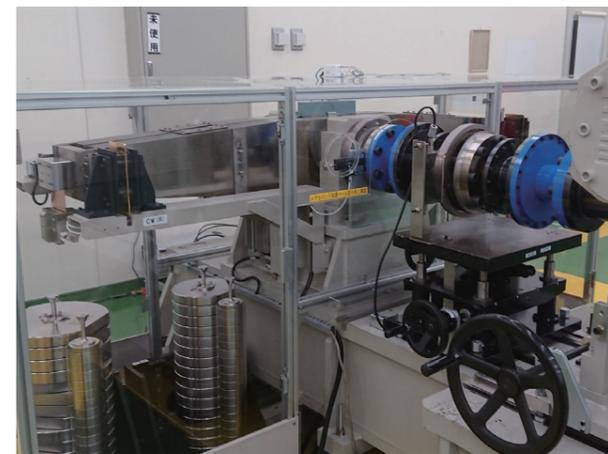
高精度トルク基準機による校正
