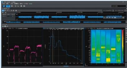
大容量の時系列データの比較・多種多様な解析が可能なソフトウェアです。FFT解析、FFTトラッキング解析、オクターブ解析などの周波数分析に加え、人の聴感を考慮した音質評価・変動音解析も可能です。気になる帯域を強調するフィルタ機能や変動音シミュレーターなどにより収録音の特徴やわずかな違いを聴いて確かめることができます。
