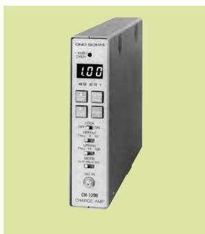
本器は電荷出力型加速度ピックアップ( NP-2000シリーズ )用のチャージアンプです。センサから出力される電荷信号を電圧信号に変換します。小型軽量ですので、幅広い用途での振動計測を可能にします。また、振動計測用に設計したことにより、取扱い操作が容易になっています。CH-1200は積分機能付で、加速度、速度、変位の切替出力が可能です。
