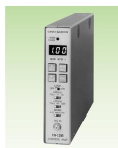
本器は電荷出力型加速度ピックアップ(NP-2000シリーズ)用のチャージアンプです。センサから出力される電荷信号を電圧信号に変換します。小型軽量ですので、幅広い用途での振動計測を可能にします。また、振動計測用に設計したことにより、取扱い操作が容易になっています。積分機能付。
