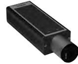
騒音計測に不可欠な音響校正器です。JIS C1515:2004 に適合しています。SC-3120は、Class1/C のピストンホンタイプの音響校正器です。250 Hz, 114 dBの音圧レベルを出力します。JIS C1509に適合しているLA-1400/4440シリーズにはSC-3120をご使用ください。SC-2120Aは、Class2のスピーカータイプです。1 kHz, 94 dBの音圧レベルを出力します。
