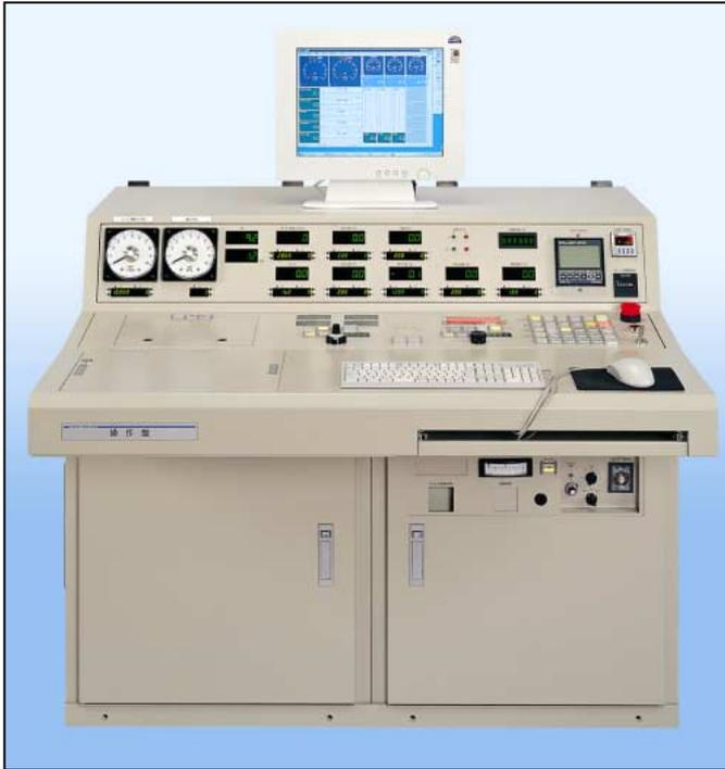
エンジン及び各種デバイスの耐久評価試験専用システムです。耐久試験に必要な各種機能を集約し、長時間の試験が安全に行えます。
