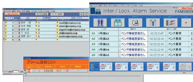
ILASシステムの監視モニター画面例です。各ベンチの運転状態及びアラーム通報リストを表示します。
