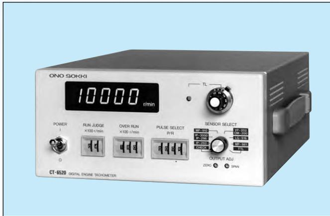
CT-6520型エンジン回転計は、逓倍演算回路方式を採用することにより、計測時間の短縮と高精度を両立した回転計です。入力パルス切換スイッチを1回転あたりに発生する信号数に合わせて設定するだけで、さまざまなエンジンの回転数計測が可能です。さらに一般の回転計としても使用できる多機能タイプの回転計です。
