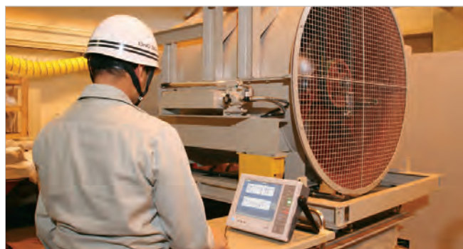
データバレットを使った大型プロアの回転振動計測
