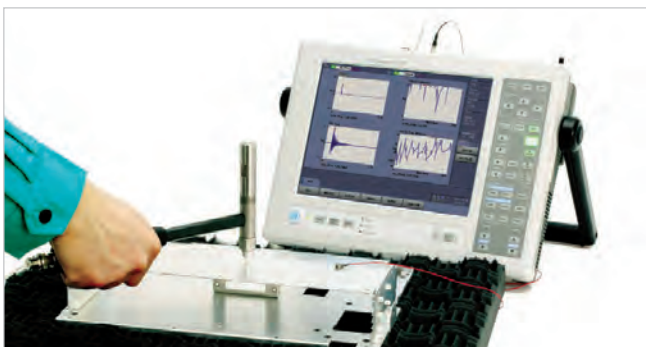
データバレットとインパルスハンマキットGK-3100、加速度検出器NPシリーズによるハンマリング計測
