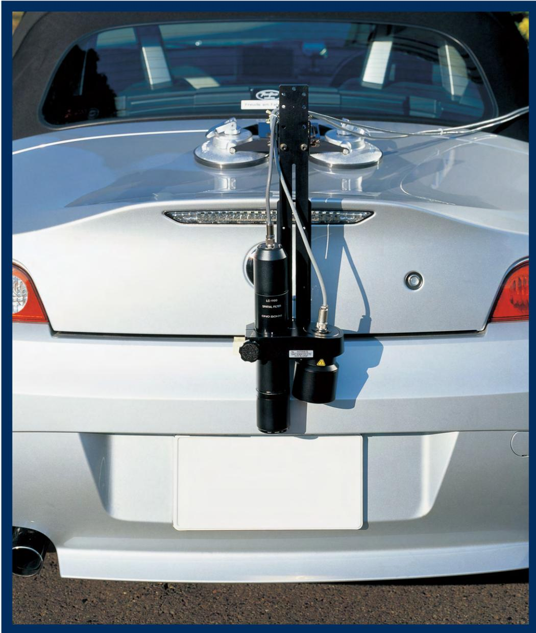
完全非接触・ノーマークで高精度な速度測定を実行する
