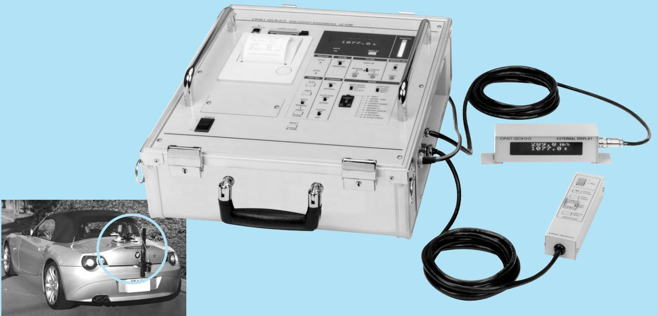
※左の写真は、本システムに含まれる空間フィルタ式速度検出器LC-1100の取付け例です。
