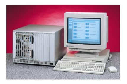
FAMS-8100は車両負荷モデル手法を用いて供試 体の各種パラメータを入力する事により、トルクコ ンパータやクラッチの特性・ミッション比の変化に 応じて動力計に対し高精度・高応答に制御指令を 出力するシステムです。
