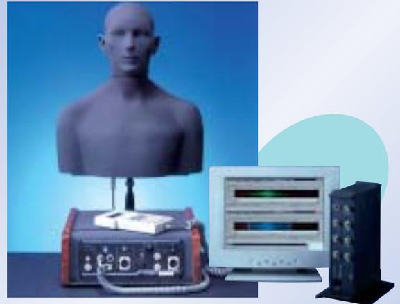
Graduoは、快適な音を創造するための評価方法として、ラウドネス、ラフネス、シャープネス、変動強度の4つのパラメータを提唱します。これらは、心理音響技術の分野における人の感性による評価です。バイノーラルヘッドとの組み合わせで、より人間の耳に近い計測・分析を実現します。
