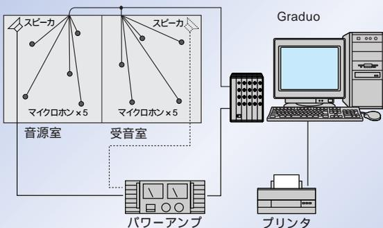
ISO140シリーズ、JIS A1409、JIS A1416～1419に対応。ホールや会議室などの建築物や建築材料を評価する際に必要とされる音響透過損失、室間レベル差、床衝撃音、吸音率、残響時間といった測定が可能です。また、測定結果はグラフやリスト表示でき、報告書の作成も容易に行えます。
