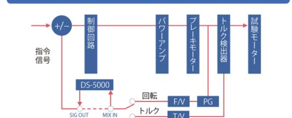
加算機能を用いることでフィードバック信号に直接計測用の信号を加算することができ、対象物の開ループ伝達関数を測定することができます。
