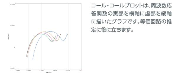
コイル・コイルプロットは、周波数応答関数の実部を横軸に虚部を縦軸に描いたグラフです。等価回路の推定に役に立ちます。
