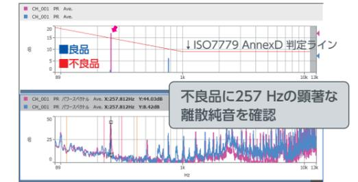
ポータブル振動計を用いた異常振動の原因究明
