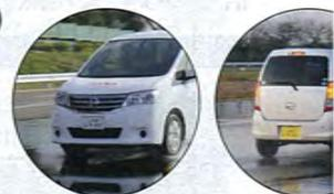
ブレーキテストでは、3台とも1人乗車と比べて定員乗車のほうが制動距離が長くなった(グラフ参照)。1人乗車との差は、ミニバンが4.3m、セダンが3.7m、軽自動車2mだった。旋回テストでは、写真のように3台とも1人乗車(右)より定員乗車(左)のほうが車幅分ほど走行ラインがふくらむ結果になり、速度を抑える必要性が確認できた。
