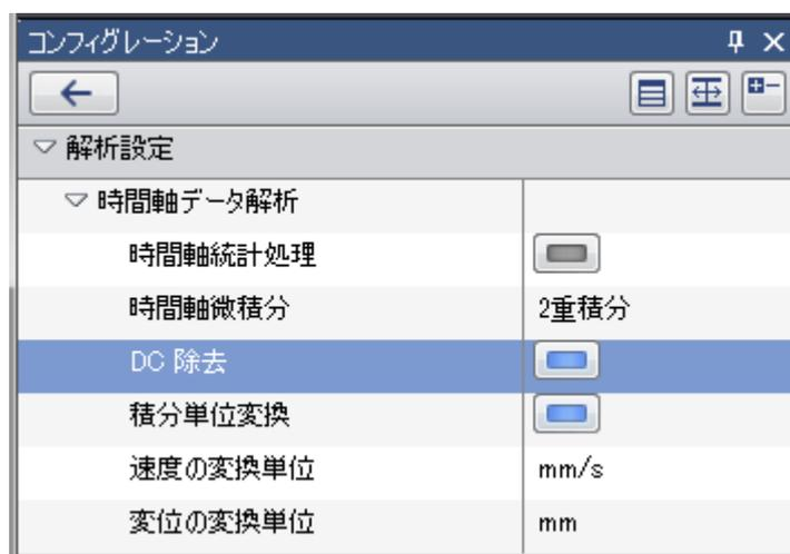
図 3 時間軸微積分機能設定画面 (解析設定メニュー ⇒ 時間軸データ解析)
