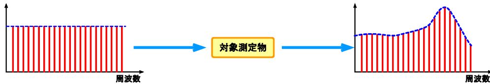
図 8 FFT 法の測定原理
