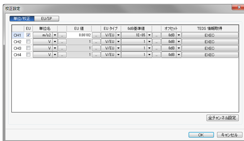
図5 DS-3000 で 1 \times 10^{-5} \text{m/s}^2 を基準加速度に設定する場合（設定例）
