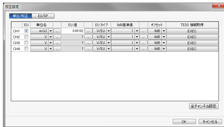
図 2 DS-3000 で 1 m/s 2 を 0 dB に設定する場合 (設定例)
