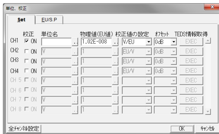
図 3 DS-0221 で 1 \times 10^{-5} (\text{m/s}^2) を基準加速度に設定する場合 (設定例)
