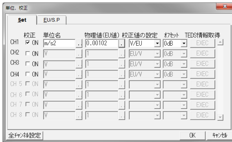
図 1 DS-0221 で 1 m/s 2 を 0 dB に設定する場合 (設定例)
