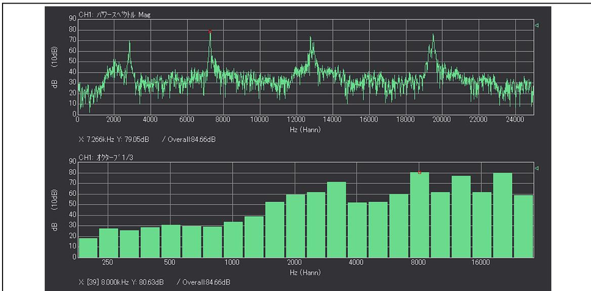
図8 自転車のベル音のFFT分析 (パワースペクトル MAX OA)
