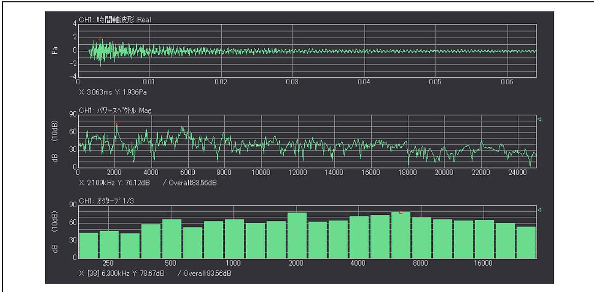
図2 コーヒー缶の打撃音のFFT分析結果 (25 kHz レンジ、4096 点)
