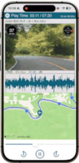
スマホアプリ「Sound One Recorder」はスマホに内蔵されたGPS、加速度センサの情報を元に「走行軌跡」「速度」「G」の変化を動画と共に収録します。アプリの起動からワンタッチで記録を開始、走る場所を問わず、実走行時の様子をそのまま記録します！
