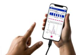
「スマホ直結NVモニター（仮称）」はお手持ちのスマートフォンに接続するだけで、いつでもどこでも振動や音圧を手軽にモニターすることができます。スマートフォンと手のひらサイズの本器だけで測るプロセスを簡素化し、より効率的なデータ収集を可能にします。日々の忙しい業務において「計測に時間を取れない」、「計測器で測るまえに」というお客様の要望を受け、日々商品を検討しています。専用のアプリを活用すればWAVフォーマットでのデータ収録はもちろんのこと、様々なソフトウェアとの連携によってデータ解析にもつながってきます。（発売は未定）
