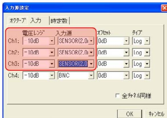
3. ファイルメニューから、[入力] → [単位校正] → [単位校正設定] で「校正可」にチェックを入れ、「EU 変更」をクリックし、各 ch の感度校正を行います (EU/V 入力)。単位は  $m/s^2$  とし、データシートに載っている値 (V/EU) の逆数を計算して入力します。NP-3560B の場合、約  $1000m/s^2/V$  です (データシートに記載された具体的な数値を入力してください)。
