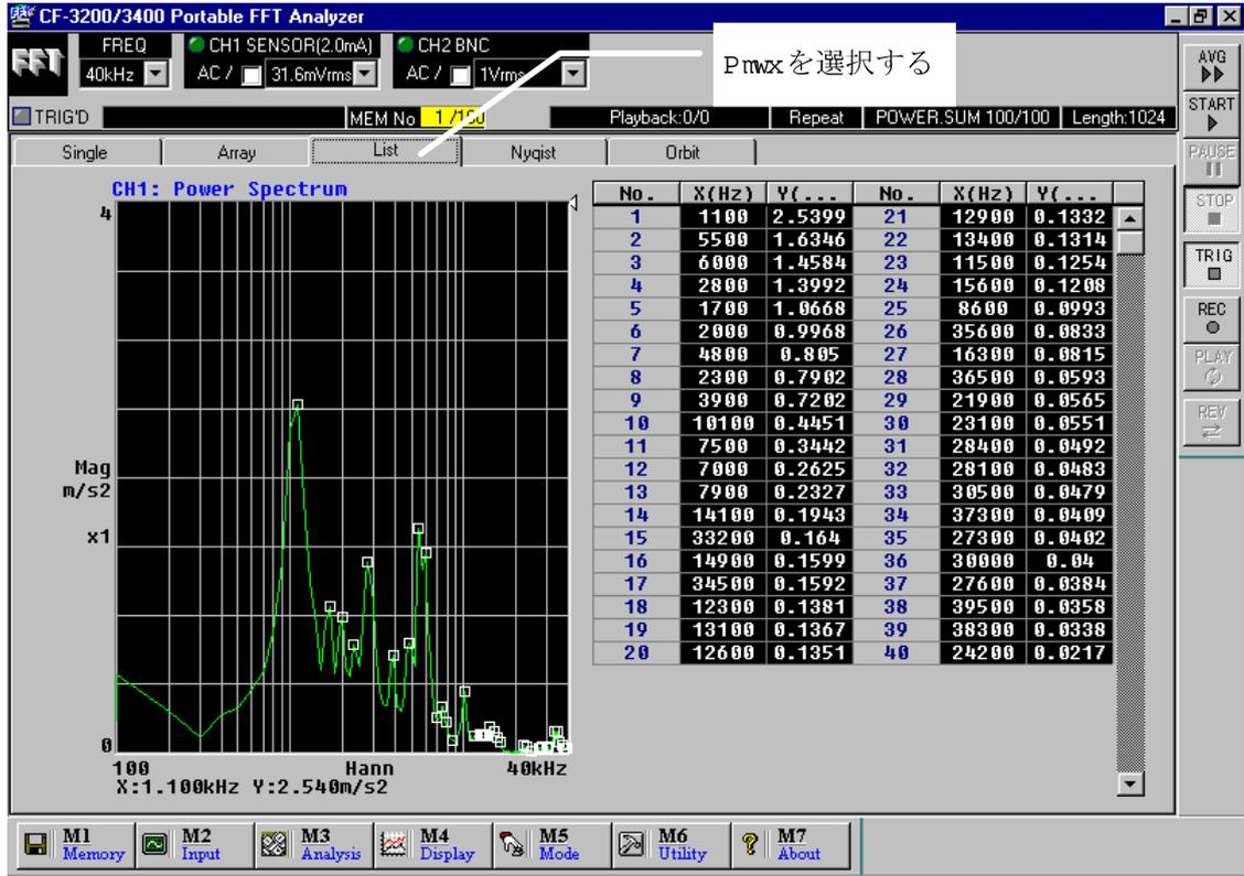
リスト表示の種類は【List Parameters】で設定します。【List Parameters】は【M4/Display】をクリックして【List Display set】を選択するか、リスト画面を表示中に画面中をダブルクリックすると表示されます。
