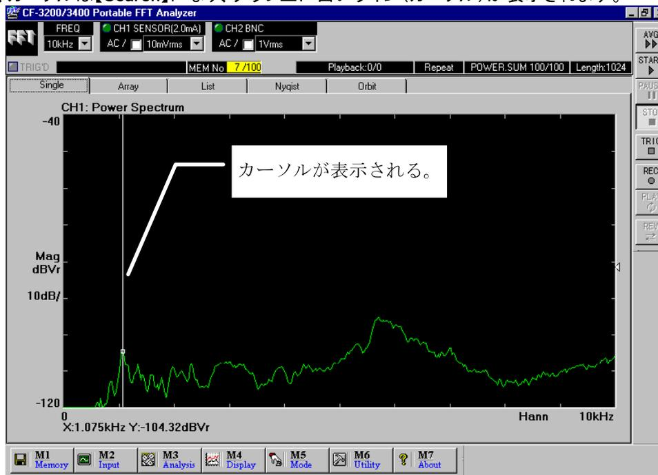
カーソルはマウスのクリックかパネルスイッチの矢印キーで任意に移動します。
