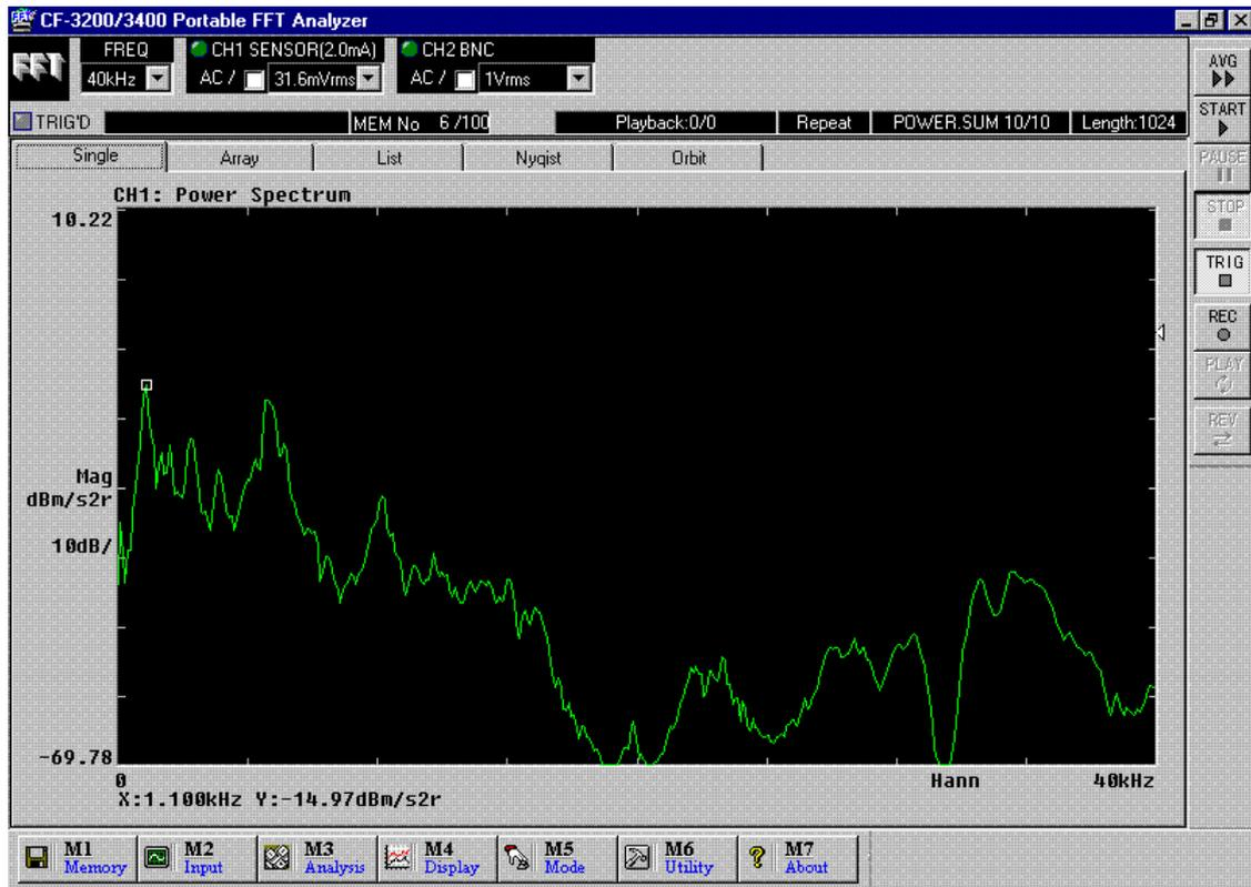
アベレージは標準設定で10回になっています。終了すると自動的にストップします。もう一度アベレージさせて、先ほどの画面と大きく違うようでしたらアベレージの回数を増やしてみます。【M2/Input】をクリックして【Average...】を選択すると設定画面が開きます。
