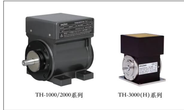
TH系列是采用新检测方式的扭矩传感器。与旧检测方式相比,相同的外观下收纳了能够提高测量精度、高速输出信号的检测机构。不再需要旧检测方式中使用的检测辅助电机,无需供电及切换旋转方向。
