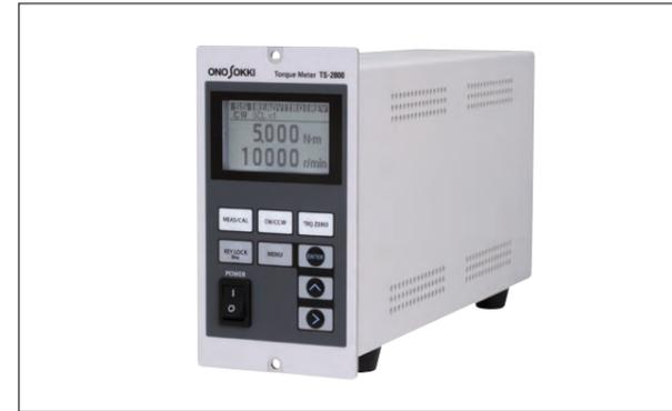
TS-2800是根据扭矩传感器和转速传感器的输入信号进行计算、显示及输出扭矩和转速的设备。能够组合的扭矩传感器分别是电磁齿轮相位差式(SS型)和新研发的电磁诱导相位差式(TH型)。
