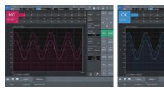
谱型比较功能(CF-0472),根据测量信号的波形形状进行比 较判定。噪声振动的时间信号波形的微妙变化,即使通过频谱 分析,也有可能无法进行简单的比较判定。通过波形形状与比 较基准线进行比较判定,信号波形的微妙变化也可以有效地 比较判定。比较基准线可通过任意设定点的连接来完成。
