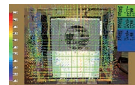
叠加到测量对象的图像,使声音的流动可视化(显示频谱图)。
