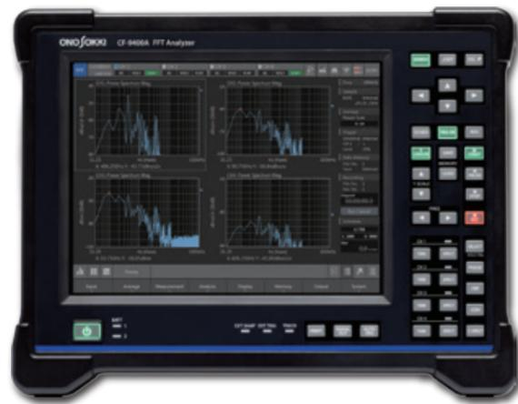
CF-9200A/9400A为集成便携式FFT分析仪。测量分析时不需要其他电脑设备，通过本机的触摸屏(静电容型)以及功能按键即可完成所有操作。本机装备有新研发的具备24位模数转换功能以及100 kHz分析功能数据处理前端，比原机型使用更加方便，可靠。可广泛地利用于电机，汽车，铁道，家电，冶金化工设备的管路泵类等机械装置，电机电子配件所产生的噪声与振动的测量分析。同时也可用于通过电磁加振机或脉冲力锤进行激励加振完成物体结构的共振频谱分析等，需要FFT分析仪进行数据分析的各种场合。
