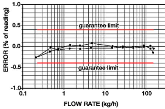
左图所示稳定流量精度和再现性，精度为读数值的 $\pm 0.35\%$ 以内(在0.23 ~ 150 kg/h时)。
