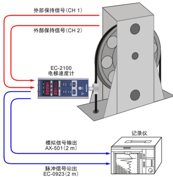
使EC-2100的周速环接触曳引机的曳引绳或曳引滑轮进行测量，利用本机的保持按键[1]和[2]，或利用外部输入保持信号，可分别测量并表示不同时机的速度数据。
