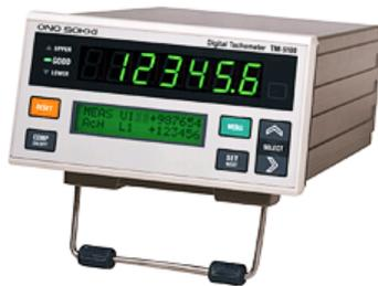
从两个旋转体接受独立的旋转信号，运算并显示各自的转速及转速比、转速差的双通道数字式转速表。对各个通道的输入信号，可以用独立的系数进行修正，任意的设定为0.0001 ~ 99.999 倍，因此，根据所测对象与用途不同而异，除转速外，还可变换为任意的物理量。例如：可以测量传送线的速度比、速度差，以及钢板、造纸、铝板等压制压延工程中的压下率(延伸率)、拉张率、滑动率等生产线上的参数测量。另外，如果每个通道内设置了独立的上、下限比较器，可对旋转体进行监视与控制。
