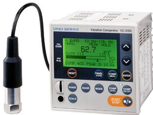
振动比较器 VC-3100 是一种高性能信号处理器，特别是能对轴承之类的产品或设备，用测振动的方法，对产品进行合格与否的检测，或对一些设备进行受伤、磨损、缺少润滑等诊断。除了测量振动的峰值和有效值，还能进行峰值系数注的分析。对轴承的异常诊断能作出根准确、更具体的判断。
