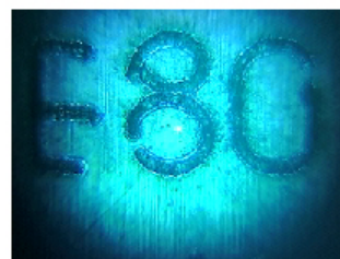
LV-0181 ( LV-1800的选配件 ) LV-0151物象镜头 ( x10 ) 约 2.1 mm x 约 1.6 mm
