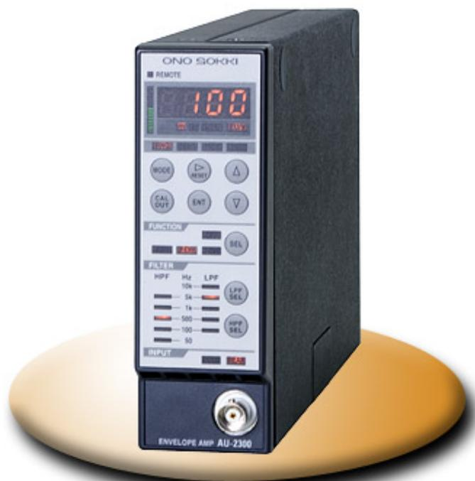
AU系列放大器作为能将音响、振动传感器测得的微小信号有效地放大,进行滤波处理等前端测量的平台,其中AU-2300为内装包络线功能的振动放大器,除了可用作滤波器方式或峰值方式等包络线功能外,也可作为加速度传感器的放大器使用。包络线处理能将振动波形的包络线成比例地输出,特别对轴承,齿轮破坏的振动测量不可缺少。
