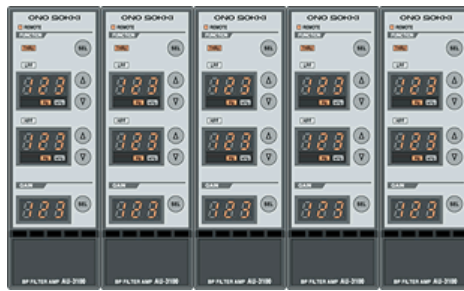
5台的BPF并联使用 5通道滤波器并联使用
