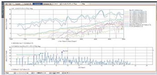
发动机振动的转速跟踪分析数据图
