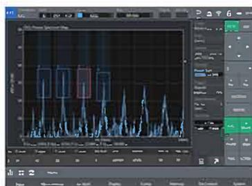
变动成分检测功能，特定频带信号的大小变动量的预处理功能。（是针对振动、噪音的周期性变动量而非频率值进行判定的功能）。在判定由电机等机器运转时发生的电度声音及颤振引起的异音及振动时，通过特定频带的变动量大小进行判定是有效的方法。CF-0473A 包括带通滤波器，用于轴承的振动分析监控的包络线处理，以及监听功能(耳机输出)等将振动状态的可听化，可由听觉进行确认。
