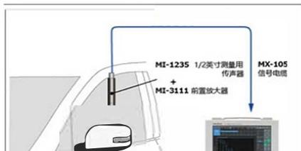
收放后视镜时电机因旋转不均匀而产生周期性变动成分的浊感异音。测量收放后视镜时的声音，用变动成分检测功能，检测变动成分，用变动设置量判定异音的有无。在不能简单地通过的测量值的大小进行有效判定时，可以利用变动成分检测功能。
