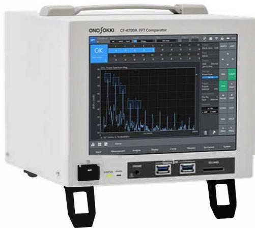
CF-4700A FFT分析比较仪是通过噪声与振动的频谱分析，可用于生产线上进行产品精密品质检查的测量仪器。搭载了本公司长年累计的FFT频率分析处理技术，通过检测特定的频率成分等进行产品的合否判定。在现有机型CF-4500 的频率成分的大小和波形判定功能之外，增加变动成分检测功能，用于检测出周期变动的声音和振动的变动量。该功能对声音和振动的周期性变动量进行判定(而不是根据声音和振动的程度)。在判定由电机等机器运转时发生的浊度声及颤振引起的异音及振动时，通过特定频带的变动量大小进行判定是有效的方法。此外，该功能还包括带通滤波器，用于轴承的振动分析监控的包络线处理，以及监听功能(耳机输出)等将振动状态的可听化，可由听觉进行确认。
