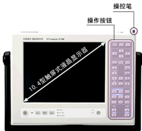
显示器采用10.4 英寸的触屏式 TFT 液晶显示器，能同时清晰地显示 4 组数据。并且直接在屏幕上操作设定，直观性强，简单易懂。
