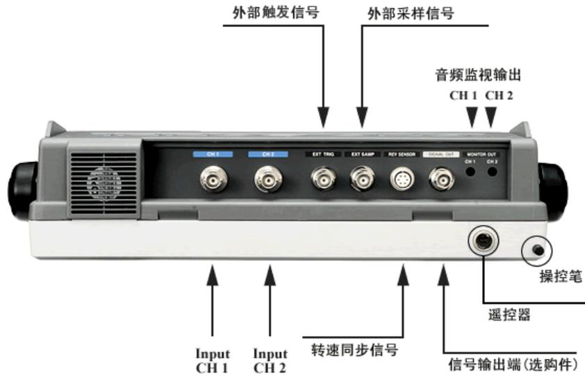
在各个通道的输入端，配有CCLD恒流源(传感器用电源)。能直接驱动加速度传感器和麦克风等需要电源的传感器。此外，还能读取TEDS传感器的数据，自动地向传感器供电并进行单位校正。
