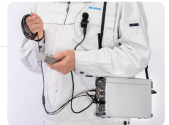
加速度センサー、イヤホンマイク、リモートコントローラー接続の様子。 *リモートコントローラーはオプションです。
