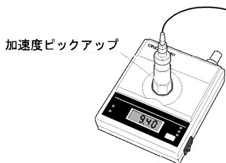
VX-1100A 簡易感度校正器 (10 m/s 2 、159.2 Hz)
