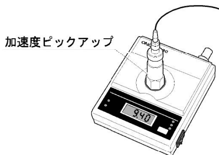
VX-1100A 簡易感度校正器 (10 m/s 2 、159.2 Hz)
