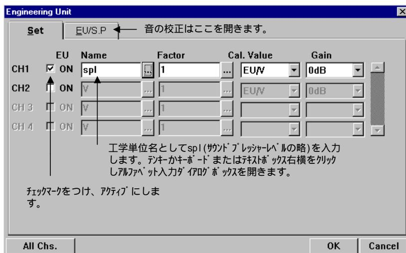
騒音計を接続している方のチャンネルのONにチェックマークをいれ、テキストボックスをアクティブにします。
