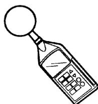
騒音計のレベルレンジを対象物から音が出ている状態で設定します。(騒音計と本体を校正後にレベルレンジを変えると整合性がとれません。)
